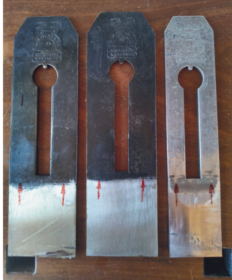
Foto de lâminas forjadas evidenciando a linha de separação entre a lâmina de Crucible Cast Steel e o corpo da lâmina.
